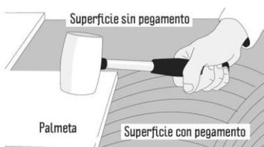
Con separador: Después de haber instalado la primera palmeta y antes de colocar la siguiente, se ponen separadores plásticos que darán la separación justa entre cada cerámica. Si se ha rebasado un poco de adhesivo entre las palmetas, se saca con un objeto que tenga punta. Puede ser un palo de fósforo o un cuchillo, ya que una vez seco ocupará el espacio que corresponde al fragüe.
