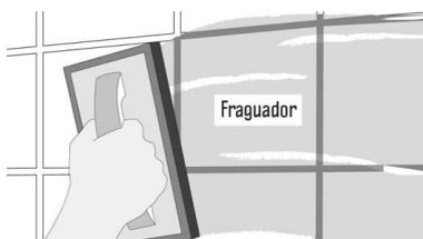
Limpieza del fragüe: Después de tener todo el muro o piso fraguado, y antes de que se seque por completo, se rebaja el fragüe entre las palmetas para que quede más bajo que la superficie de la cara de las cerámicas.
