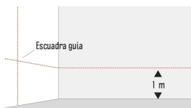
4. Trazar el nivel del muro: Para sacar el nivel del piso, es necesario previamente sacar el nivel de al menos dos de los muros.
